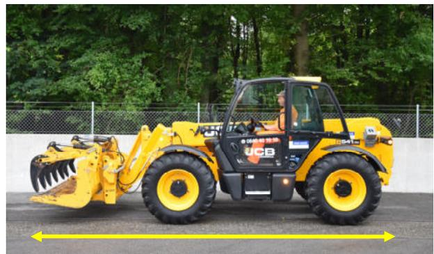
Fahrzeuglänge mit Greifer: ca. 6.30 m - Fahrzeughöhe: ca. 2.50 m.
