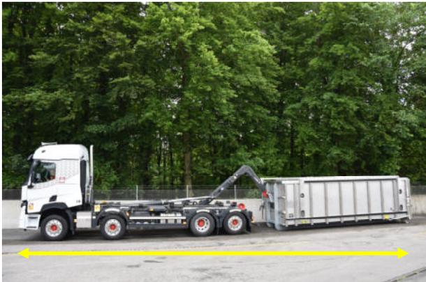
Länge Fahrzeug mit abgesetzter Seuchenmulde: ca. 17.00 m.
