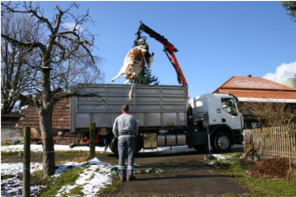
Mit diesem 16 t Fahrzeug können mit Hilfe eines Hebekrans ca. 13 GV-Einheiten (z. B. Kühe) mit einem Gesamtgewicht von ca. 6.8 t aufgeladen und abtransportiert werden.
