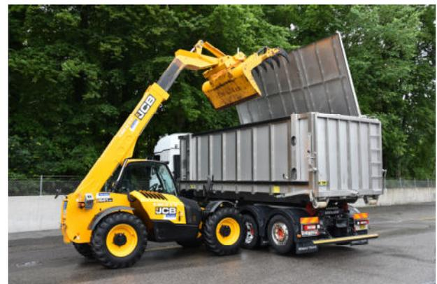
Bei wenig Platz für Absetzen der Mulde kann auch direkt in die Seuchenmulde auf dem Camion geladen werden.
