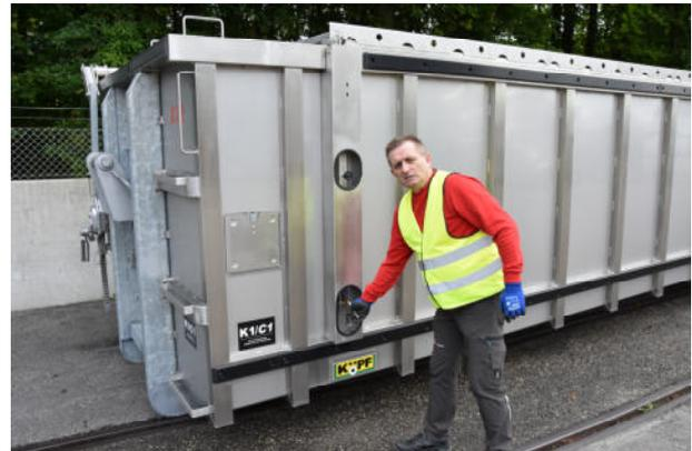
Bei den seitlichen Öffnungen kann die Sicherung des Deckels gelöst werden.
