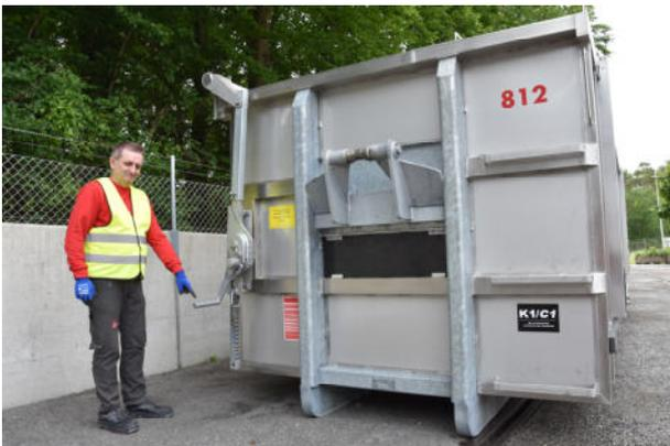
Zum Öffnen des Deckels befindet sich an der Vorderseite der Mulde eine gesicherte Handkurbel.
