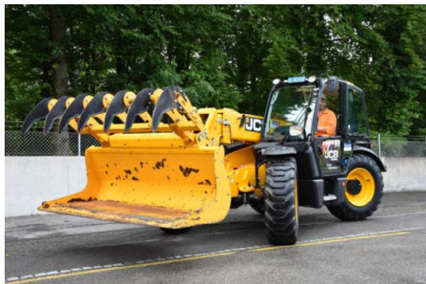
Je nach Art der Seuchentiere können verschiedene Greifer und Schaufeln montiert werden.
