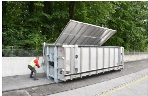
Durch manuelles Drehen der Kurbel kann der Muldendeckel mit weg Kraft geöffnet oder geschlossen werden (Links- bzw. Rechtsdrehen).
