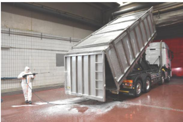
Mit speziellen Schaumlanzen wird eine gleichmässige Verteilung des Reinigungs- und Desinfektionsmittels erreicht.
