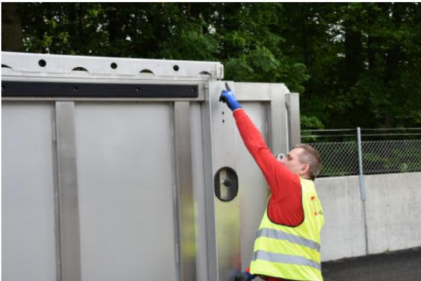
Vor dem Öffnen des Muldendeckels muss die Sicherung gelöst werden.
