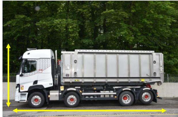
Fahrzeuglänge: ca. 10.00 m - Fahrzeughöhe: ca. 3.90 m – Fahrzeugbreite: 2.50 m (ohne Spiegel).
