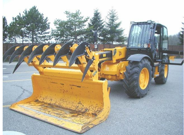
Véhicule de ramassage moderne et performant à quatre roues motrices, d'une hauteur de levage pouvant atteindre 7 m.
