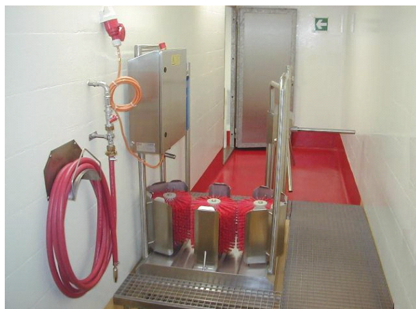
Sas de nettoyage entre les zones impure (réception des matières premières) et pure (production).
