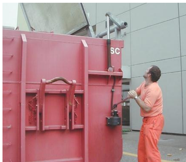
Une pompe hydraulique facilite l'ouverture manuelle du couvercle.
