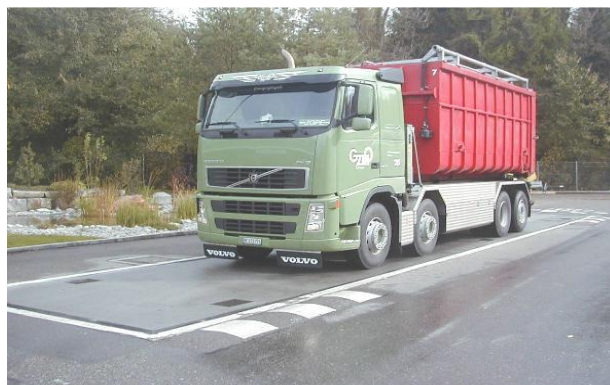
A l'arrivée, le camion est pesé sur une balance électronique.
