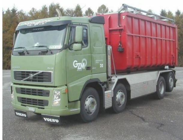
Une flotte de camions « maison » modernes, équipés de crochets pour le transport des grandes bennes à cadavres. Les dimensions de véhicule sont approx : L : 10.0 m / L : 2.5 m / H : 4.0 m
