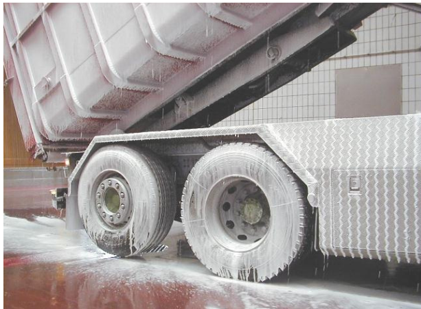
Des lances à mousse spéciales permettent une répartition régulière des produits de nettoyage et de désinfection.
